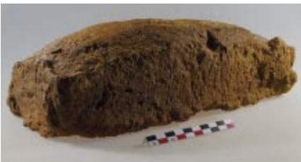
Abb. 22 Verbrannter Ziegel mit Resten des Formvorgangs
