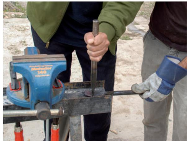
Solange das Eisen noch weich ist, kann beispielsweise eine gerade Kante abgeschlagen werden.
