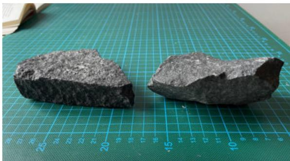
Für die kleinen Zwischenräume eignen sich scharfkantige Abschläge aus Basalt besonders gut, die sog. Basalt-Linsen (die Form ist namensgebend). Die Abschläge lassen sich sehr gut aus altem Material mit Hilfe eines Spreng eisens herstellen.
