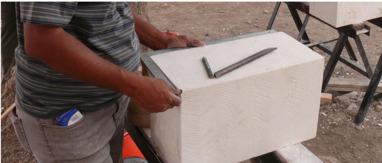
**Der Winkel** ist ein technisches Hilfsmittel aus Eisen. Er besteht aus zwei geraden Teilen, die genau im Winkel von 90 Grad zueinander stehen.
