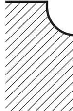
Kehlen sind gerundete Hohlformen mit unterschiedlichen Radien. Man findet sie zum Beispiel bei Gesimsen, Gewänden, Säulenbasen oder auch Kapitellen. Das Bild zeigt eine Viertelkehle, die in einer ebenen Fläche ausläuft.
