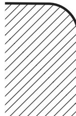
Die Abrundung einer Kante geschieht durch viele kleine Fasen. Abschließend wird parallel zum Verlauf des Profils die Rundung mit dem Scharriereisen nachgearbeitet.
