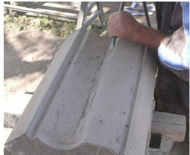
Mit dem Drucklufthammer wird das Gestein längs zur Schneidrichtung abgearbeitet. Wenn quer zum Schnitt gearbeitet wird, besteht die Gefahr, dass das Gestein nach unten ausbricht.
