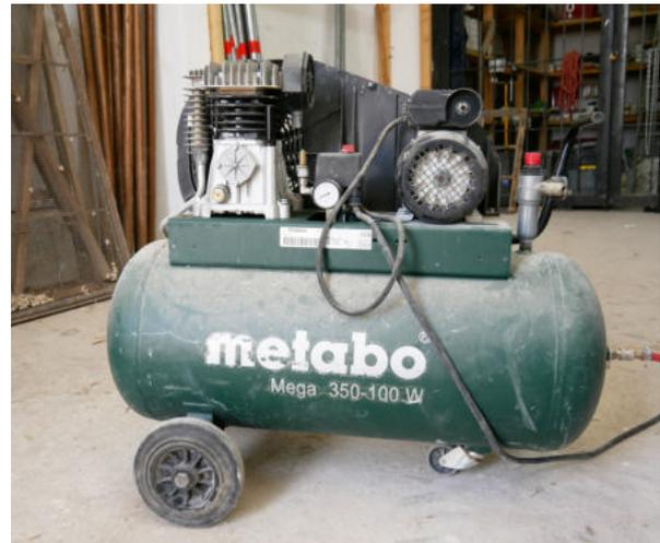
Der Kompressor benötigt in der Regel einen 220 Volt-Anschluss. Größere Kompressoren benötigen aber auch 380 Volt.
