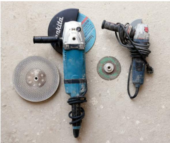
Winkelschneider gibt es in verschiedenen Größen. In der Regel wird zwischen 125 mm und 230 mm Durchmesser der Trennscheibe unterschieden. Die Tiefe der Schnitte beträgt zwischen 4–8 cm.
