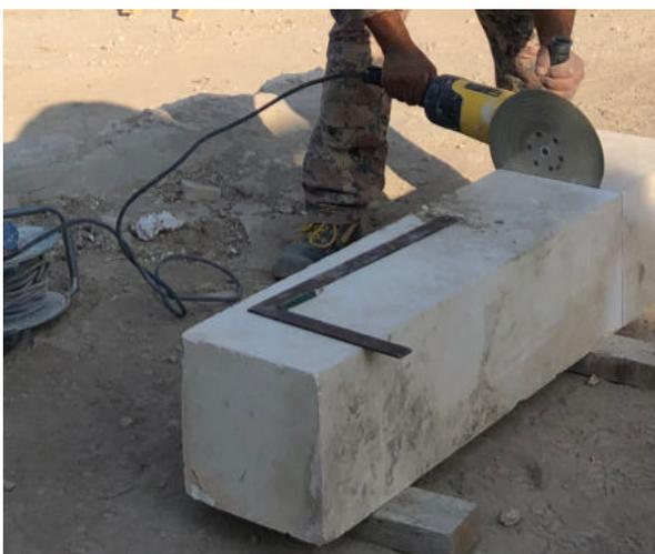
Der große Winkelschneider (230 mm) wird in der Regel für grobe Vorarbeiten verwendet. Für eine bessere Standsicherheit wird das Werkstück am Boden bearbeitet.
