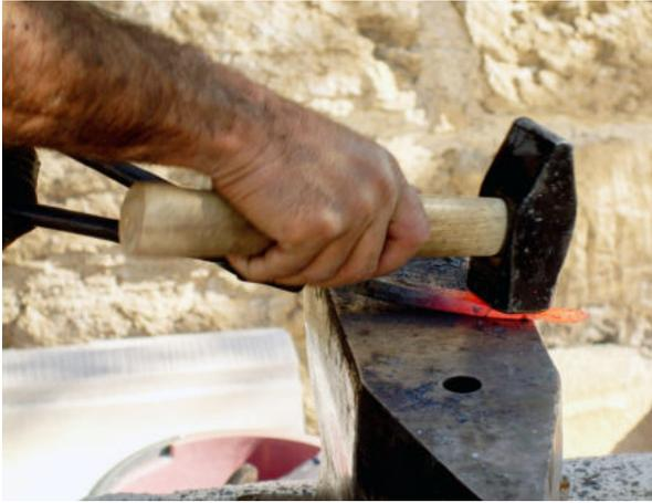
Wenn das Eisen die richtige Temperatur hat, wird das Werkzeug mit dem Hammer geformt. Solange das Eisen rot-glühend ist, kann es mit dem Hammer leicht in Form geschlagen werden.
