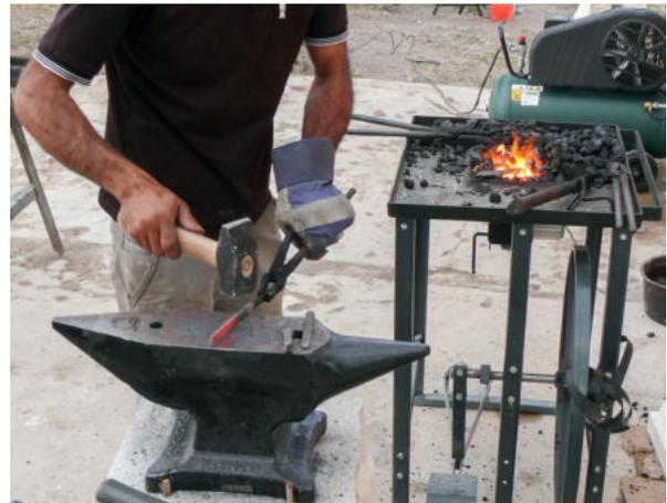
In der Regel kühlt das Eisen nach einigen Schlägen deutlich ab. Dann wird das Eisen wieder ins Feuer gelegt und erneut zum Glühen gebracht.
