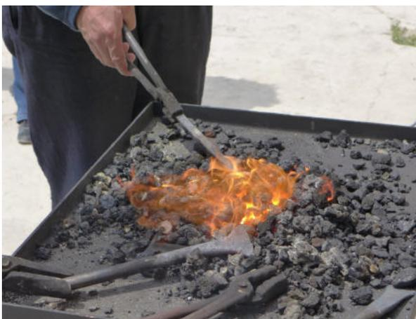
Mit dem Schmiedefeuer werden die Eisen bis zum Glühen erhitzt. Die Temperatur des Feuers muss dabei zwischen 950 °C und 1250 °C liegen.
