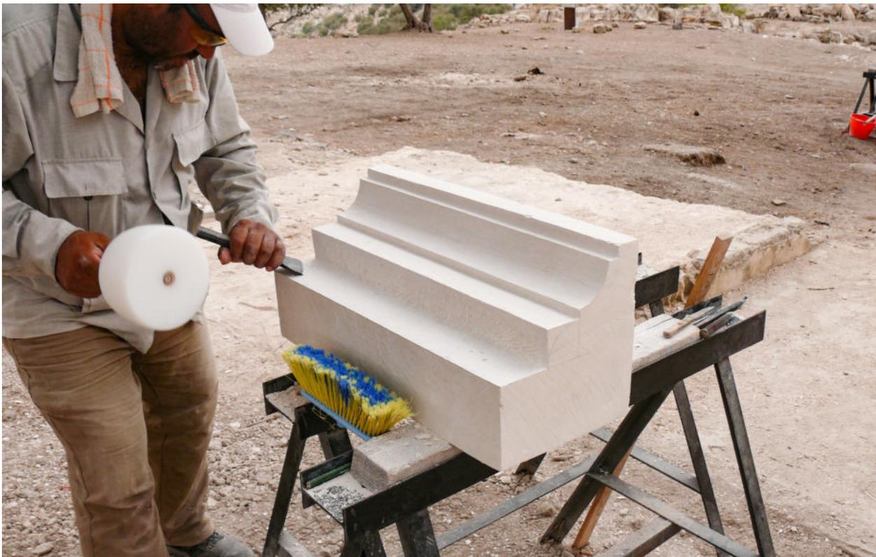
Die Bilder 1 bis 10 zeigen exemplarisch die Abfolge der Schritte, die für die Herstellung eines einfachen, aus Hohlkehle und Viertelstab bestehenden Profils nötig sind.
