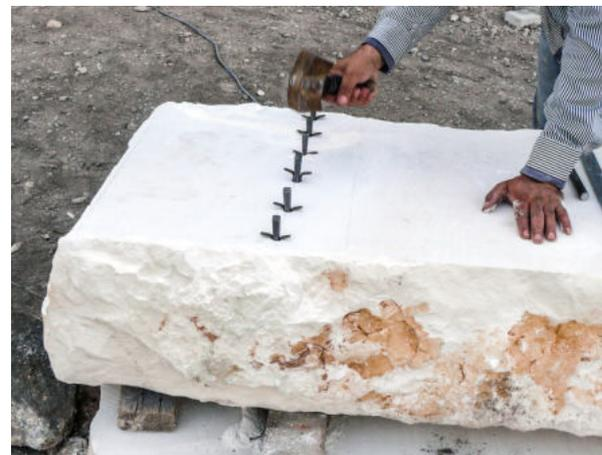
Wenn ein Bohrhämmer zur Verfügung steht, wird das Patent-Spalten angewendet.
