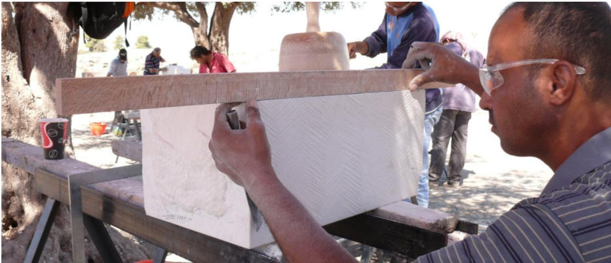
**Das Richtsheit** ist eine gerade Latte aus Hartholz, die vom Tischler hergestellt wird. Wichtig ist, dass das Richtsheit länger als das Werkstück ist.
