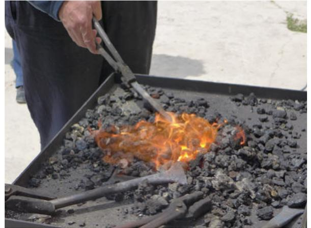
باستخدام نيران الحدادة، يتم تسخين الحديد حتى يتوهج. يجب أن تكون درجة حرارة النار بين ٩٥٠ و ١٢٥٠ درجة مئوية. ومن أجل الوصول إلى درجة الحرارة المناسبة، نحتاج إلى فحم الحدادة أو فحم الكوك، ويتم عادة الاستعانة بمنفاخ النار.
