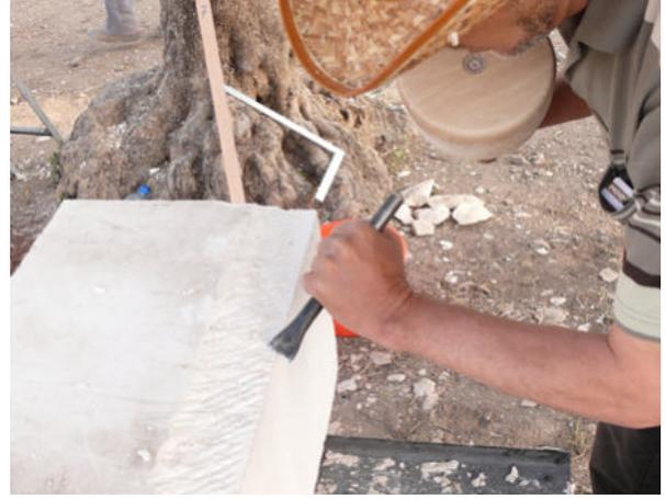
**خامساً:** ضربة الحافة يتم التحقق من دقتها باستخدام المسطرة التوجيهية. المناطق التي لاتزال مرتفعة يتم تحديدها بقلم رصاص وإعادة العمل عليها.
