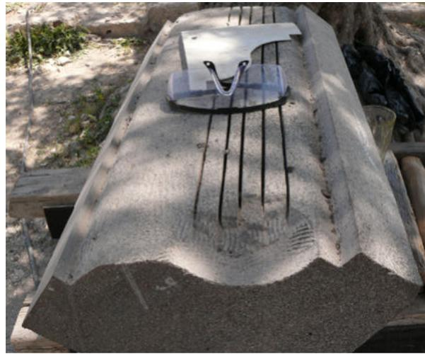
استخدام المطرقة التي تعمل على الهواء المضغوط تتم معالجة الصخرة بالطول باتجاه القطع. إذا تم العمل على الصخرة بجانب القطع أو عبر القطع، هناك خطر من أن الصخرة سوف تنكسر للأسفل. كما هو الحال مع الأدوات اليدوية، يجب عدم معالجة أو العمل على الكثير من الصخور مرة واحدة.
